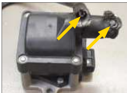
Imagen: fallo de contacto
