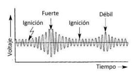
Las vibraciones provenientes del motor cuando detona provocan que el elemento piezoeléctrico genere voltaje. Este voltaje de salida del sensor knock es más alto justo en ese momento. Lo cierto es que sensor knock todo el tiempo está generando voltaje, es solo que cuando el motor comienza a detonar por el motivo que sea, es cuando el sensor comienza a generar más voltaje y la PCM al darse cuenta del incremento realiza los ajustes necesarios para evitar la detonación del motor.
