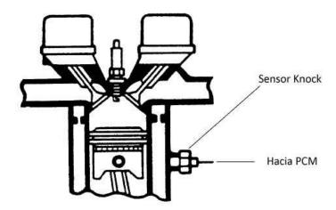
Dentro del sensor knock existe algo que se conoce como "material piezoeléctrico". Los elementos piezoeléctricos son materiales que han sido preparados en laboratorios con materiales químicos que generan voltaje cuando se les aplica presión o vibración. Los
